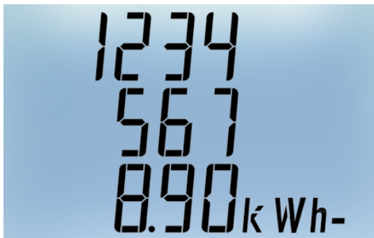
Energia attiva di sistema prodotta (Unico Numero espresso su 3 righe. Nell'esempio illustrato il conteggio corrisponde a -12345678,90kWh)
