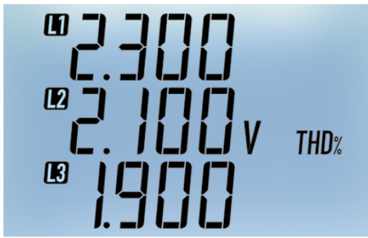
THD % delle tensioni
