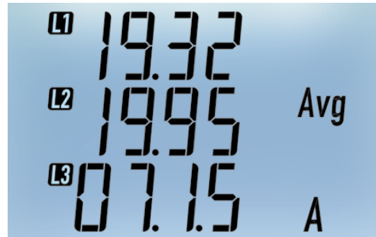
Correnti medie (Media mobile in un tempo selezionabile, vedere configurazione dello strumento)
