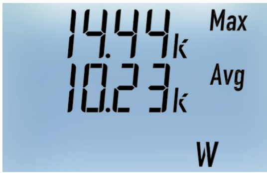
Potenza attiva media e Punta massima (Media mobile in un tempo selezionabile, vedere configurazione dello strumento)
