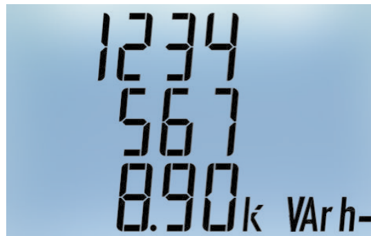
Energia reattiva di sistema prodotta (Unico Numero espresso su 3 righe. Nell'esempio illustrato il conteggio corrisponde a -12345678,90kvarh)
