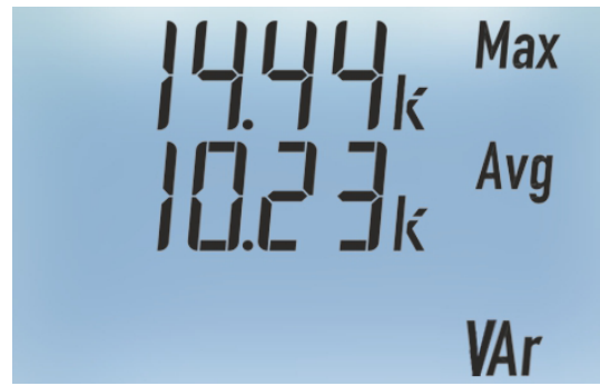
Potenza reattiva media e Punta massima (Media mobile in un tempo selezionabile, vedere configurazione dello strumento)
